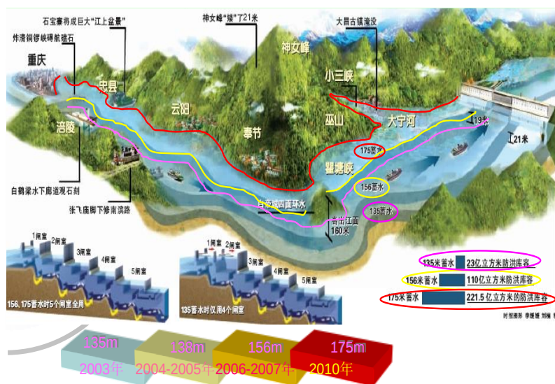
图2 三峡库区蓄水影响范围
